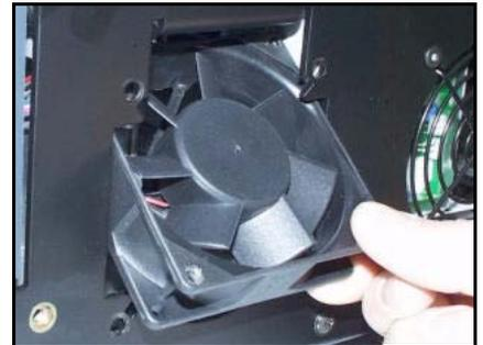
**Fig. 108 Remove fan bottom first**
