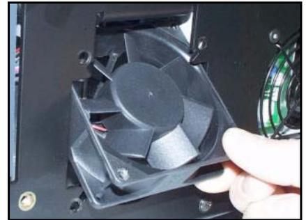
Fig. 108 Remove fan bottom first
